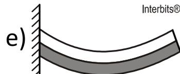
4. (Fuvest) Uma lâmina bimetálica de bronze e ferro, na temperatura ambiente, é fixada por uma de suas extremidades, como visto na figura abaixo.
