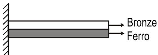
Nessa situação, a lâmina está plana e horizontal. A seguir, ela é aquecida por uma chama de gás. Após algum tempo de aquecimento, a forma assumida pela lâmina será mais adequadamente representada pela figura:
