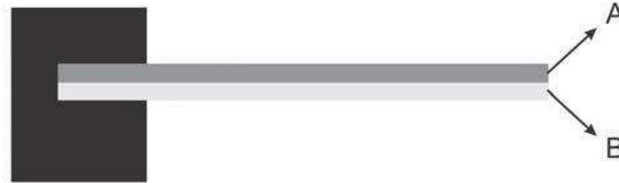
Considere que ambas as lâminas estão inicialmente sujeitas à mesma temperatura  $T_0$ , e que a relação entre os coeficientes de dilatação linear seja  $\alpha_A > \alpha_B$ . Ao aumentar a temperatura da lâmina bimetálica, é correto afirmar que
