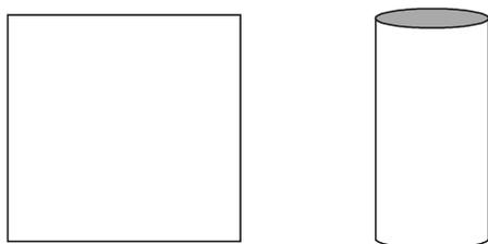
Uma placa metálica quadrada é dobrada de modo a formar um cilindro (sem fundo e sem tampa), como ilustrado. O volume no interior desse cilindro é 18 litros. Ao ter sua temperatura aumentada de  $40 \text{ }^\circ\text{C}$ , a placa dilata de forma que sua área aumenta de  $72 \text{ mm}^2$ . Considerando-se  $\pi = 3$ , o coeficiente de dilatação linear do material do qual a placa é constituída vale, em  $^\circ\text{C}^{-1}$ ,
