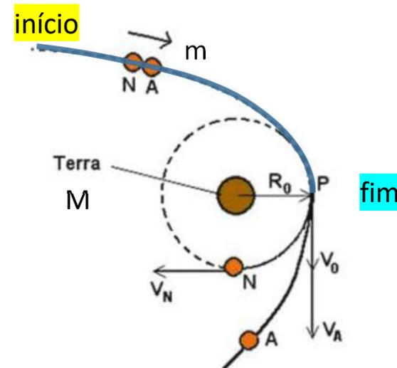
A nave N passa a percorrer, em torno da Terra, uma órbita circular de raio  $R_0$ , com velocidade  $v_N$  (a ser determinada). Suponha que a Terra esteja isolada no espaço e em repouso.
