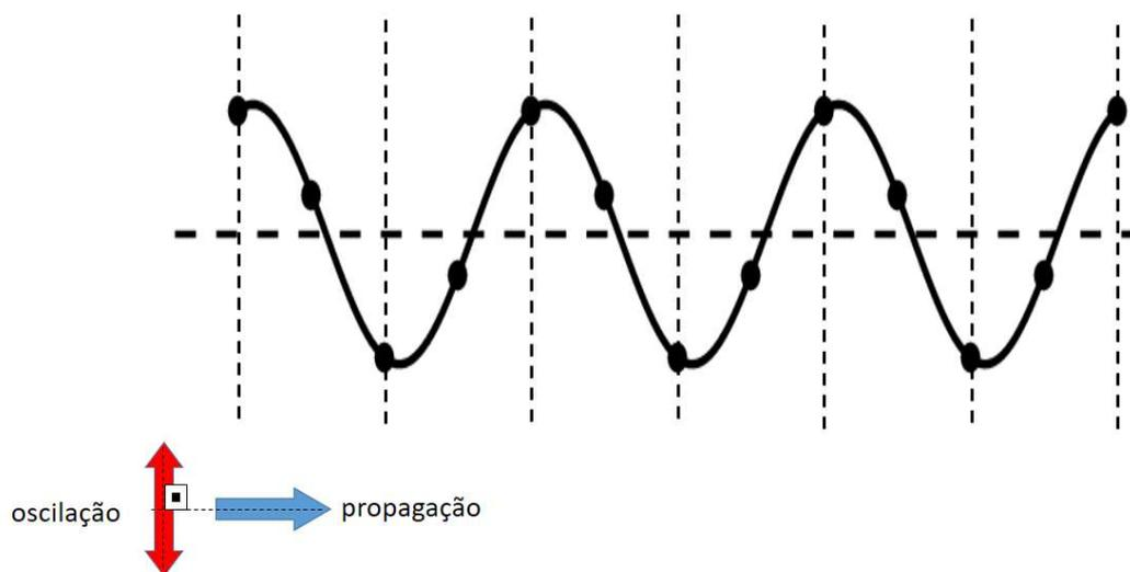
Propagação na direção perpendicular à oscilação.
