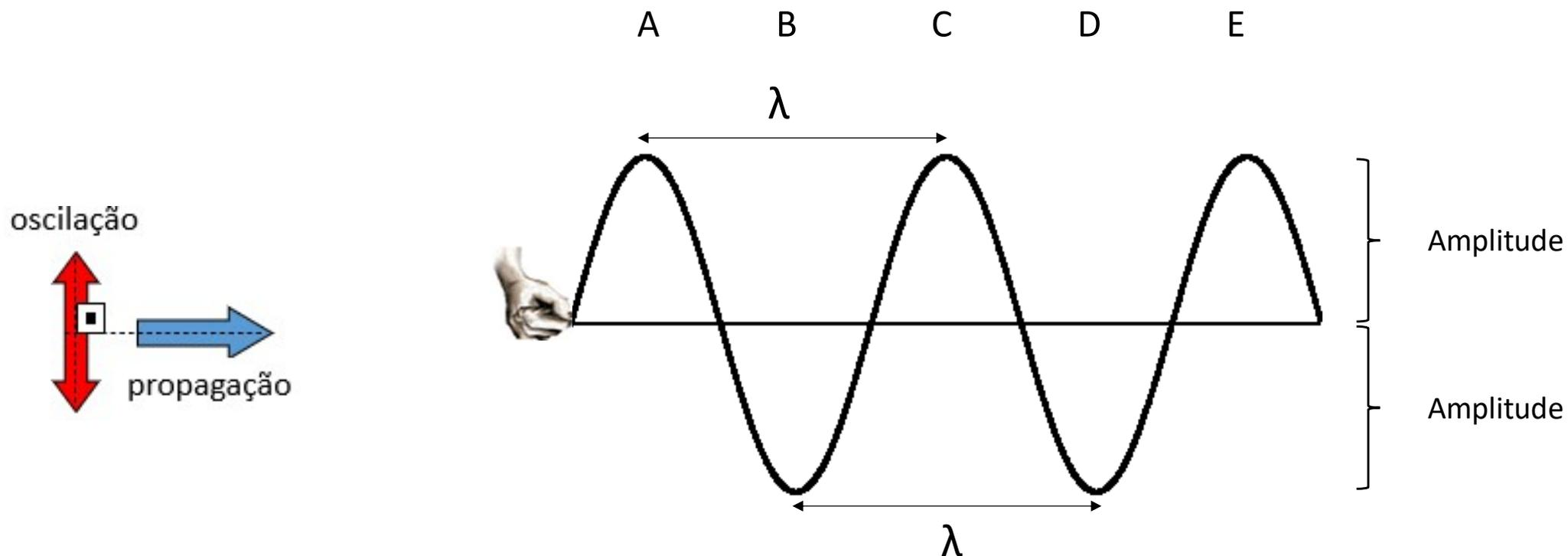
**Oscilação Completa:** ocorre quando um ponto oscila e retorna a sua configuração inicial e o ciclo começa a se repetir. Para uma onda **senoidal**, em uma oscilação completa, um ponto percorre uma distância que corresponde a quatro amplitudes ( $4 A$ ).
