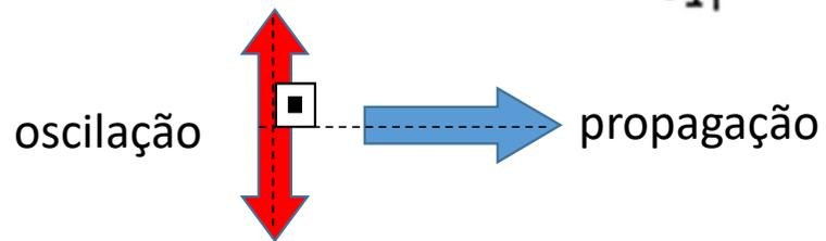
Propagação na direção perpendicular à oscilação.
