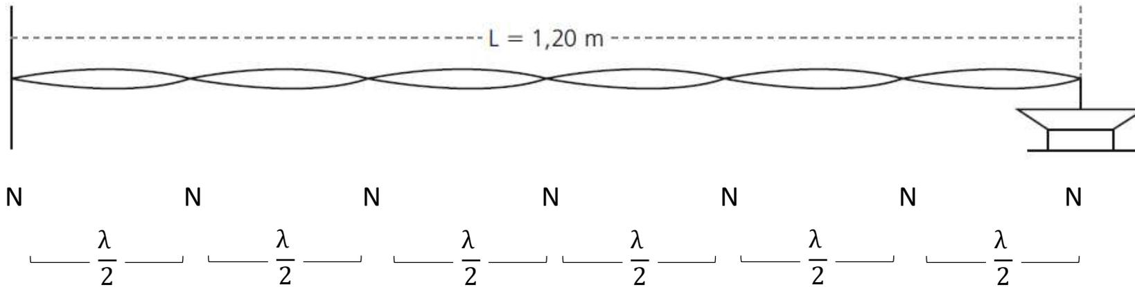
a) O comprimento de onda da onda estacionária.
