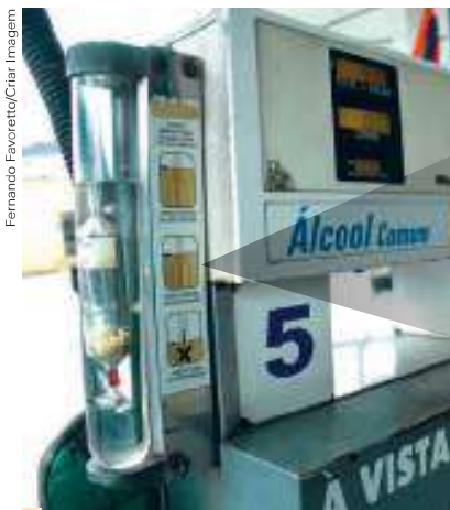
Densímetro utilizado em postos de combustíveis.
