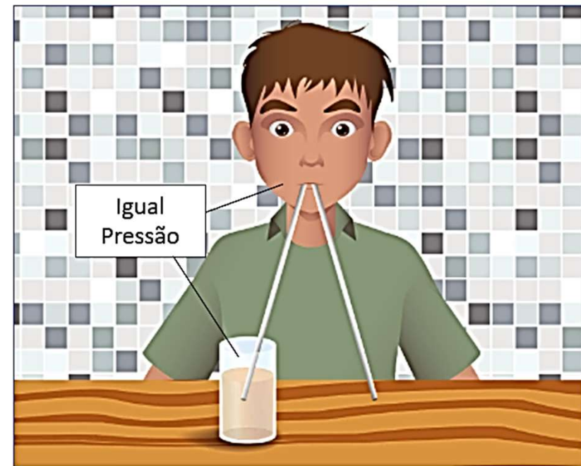
Não há diferença de pressão: o líquido não sobe
