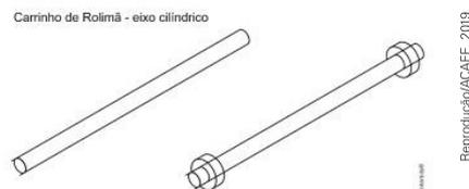
Ao construir devemos encaixar firmemente os rolamentos no eixo cilíndrico de determinado metal com diâmetro um pouco maior que o diâmetro interno do rolamento de aço. Para esse procedimento aquecemos ambos para o encaixe e depois resfriamos. Sendo assim, o coeficiente de dilatação do metal utilizado em relação ao coeficiente de dilatação do aço deve ser:
