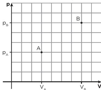
Na transformação de A para B, o gás trocou certa quantidade de calor  $Q_{AB}$  e houve realização de trabalho da força de pressão desse gás ( $\tau_{AB}$ ). Entre esses dois estados a variação de energia interna foi  $\Delta U_{AB}$ .
