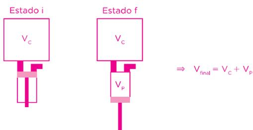
Logo, como a transformação gasosa entre os estados i e f é isotérmica, tem-se:  $p_i V_i = p_f V_f \Rightarrow 33 \cdot 2 = p_f \cdot 2,2 \therefore p_f = 30$  Pa
