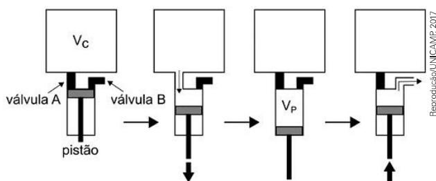
Considere que o ar se comporte como um gás ideal e que, durante o ciclo completo, a temperatura não variou. Se a pressão inicial na câmara é de  $P_i = 33$  Pa, a pressão final na câmara após um ciclo de bombeamento será de
